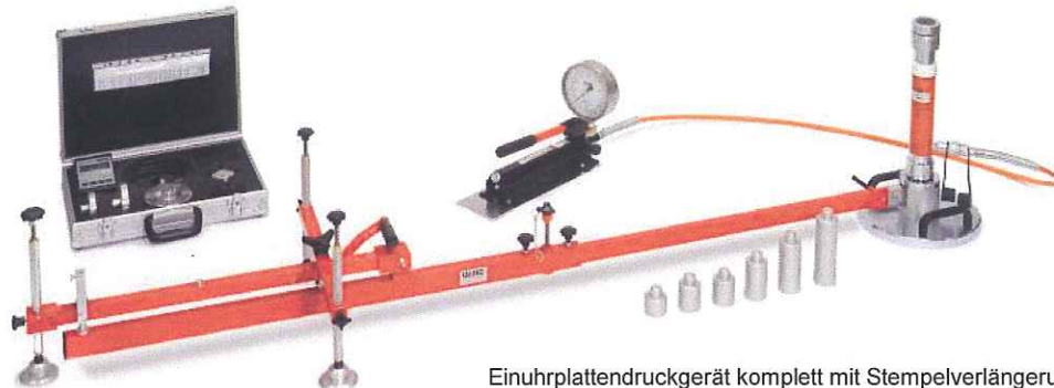
Einuhrplattendruckgerät komplett mit Stempelverlängerungen (FV 21000) und Kraftmessdose mit digitaler Anzeige (FV 21320)
